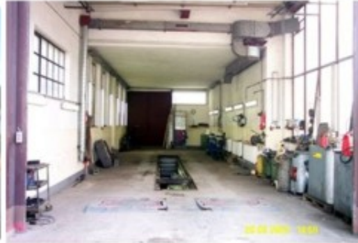
Bremsenprüfstand und Montagegrube
